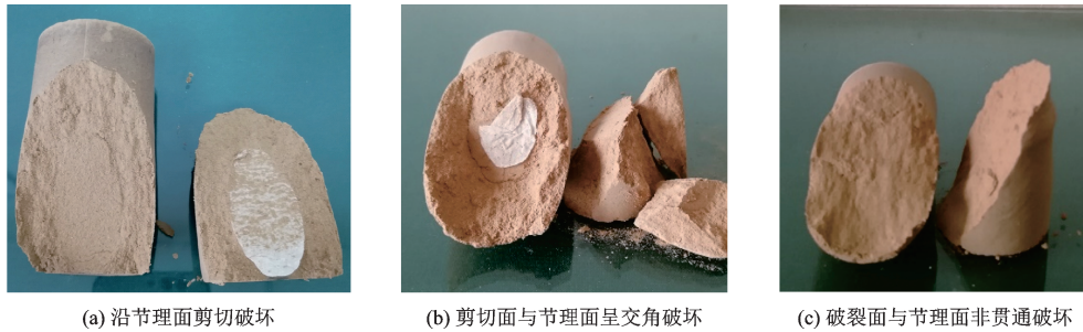
图10 围压作用下含单条非贯通节理试样典型破坏特点
